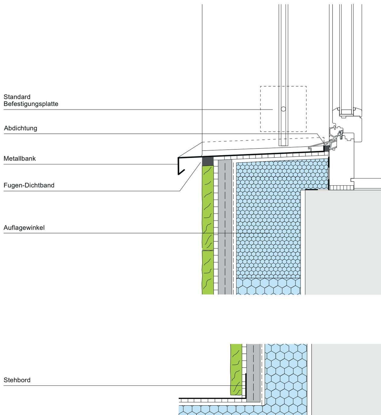
Der Anschluss des Fensterrahmens an den angrenzenden Bauteil muss warmseitig luftdicht ausgebildet werden. (SIA Norm 331 Fenster)
