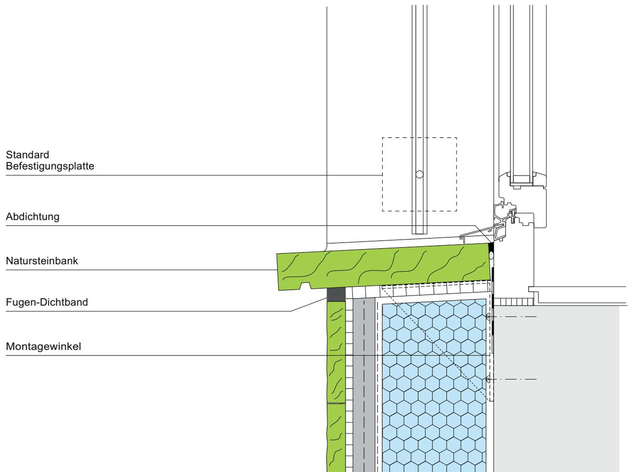
Der Anschluss des Fensterrahmens an den angrenzenden Bauteil muss warmseitig luftdicht ausgebildet werden. (SIA Norm 331 Fenster)
